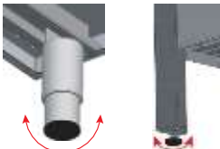
4. Ábra; az eszköz vízszintbe állítása
