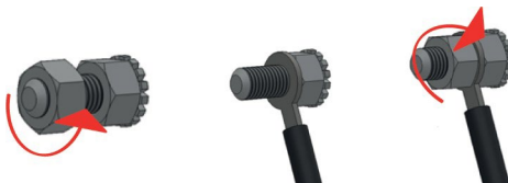
7. ábra A készülék csatlakoztatása a potenciálkiegyenlítő rendszerhez
