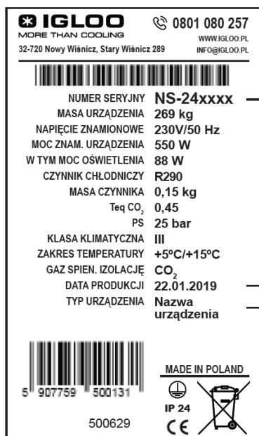
Abb. 13 Beispiel eines Typenschilds
