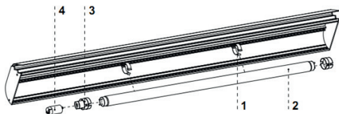
Abb.14 Austausch der Leuchtlampe
